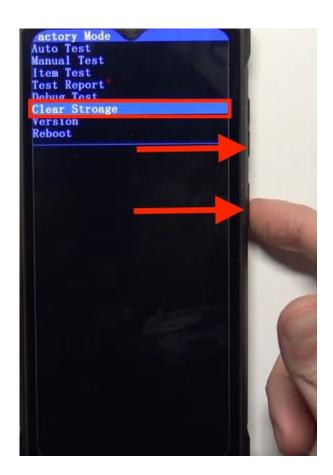
5. Das Gerät wird nun auf die Werkseinstellungen zurückgesetzt und neu gestartet. Dies kann einige Minuten dauern. Sobald der Neustart abgeschlossen ist, kannst du es neu einrichten.
